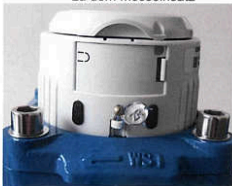
Sicherungsstelle Zählwerk WSD zu dem Messeinsatz
