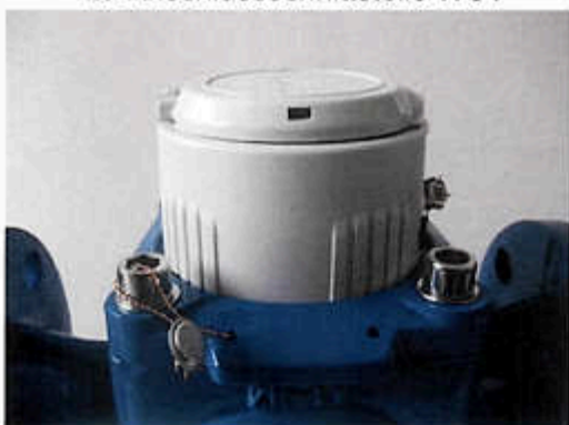
Sicherungsstelle Messeinsatz WSD zu Anschlusschnittstelle WS1
