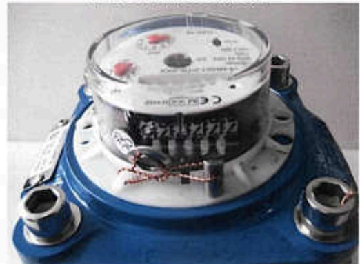
Sicherungsstelle Zählwerk WSN zu dem Messeinsatz
