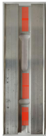
ilustrační foto nanesení lepidla na zadní desku
